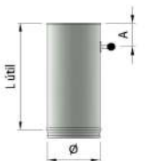
BIDA COMPUERTA 0,5 m CON TIRADOR HANDLE DAMPER 0,5 m
