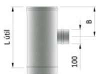
BJTJ TE DE 0,5M REGISTRO Ø100 Ø100 INSPECTION TEE 0,5M
