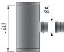
KWTS TE 90° 0,5M CON REGISTRO Ø100 TEE 90° 0,5M WITH Ø100 INSPECTION DOOR
